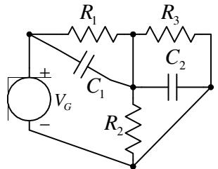
2. a) [22] Primenom **metode potencijala čvorova** izračunati potencijale svih čvorova u kolu sa slike, kao i struje  $I_A$ ,  $I_B$  i  $I_C$ .
